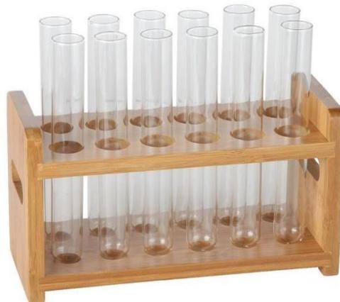
Gambar 18. Tabung reaksi dan rak tabung reaksi
